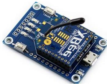
Ilustración 3 Módulo Xbee y explorer.
