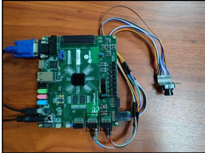
*Ilustración 3.52 Conexión FPGA-Module OV7670*
