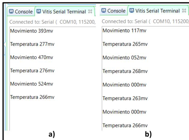
Ilustración 4.8 Terminal serial de Vitis a) sin obstáculos, b) con obstáculo.
