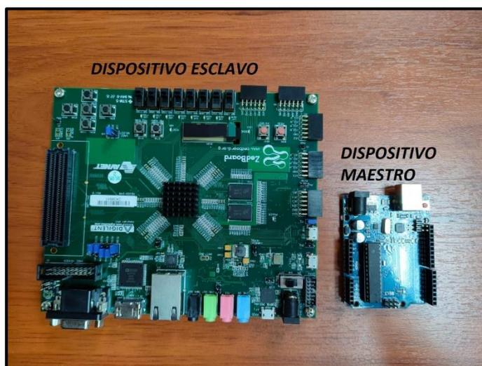
Ilustración 4.1 Dispositivo esclavo y maestro
