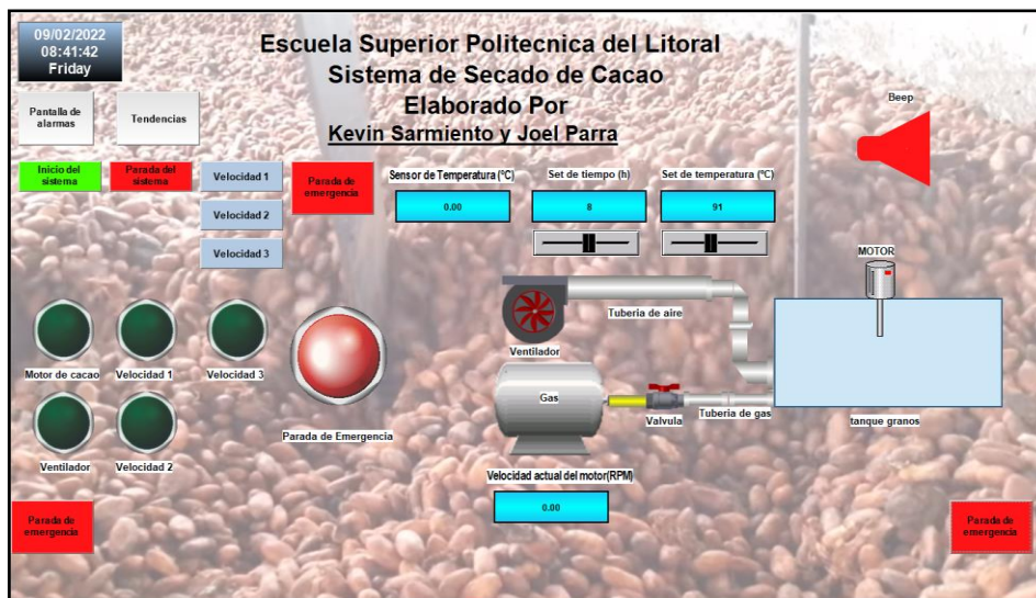
Figura 3-20 Sistema SCADA al activar paro de emergencia
