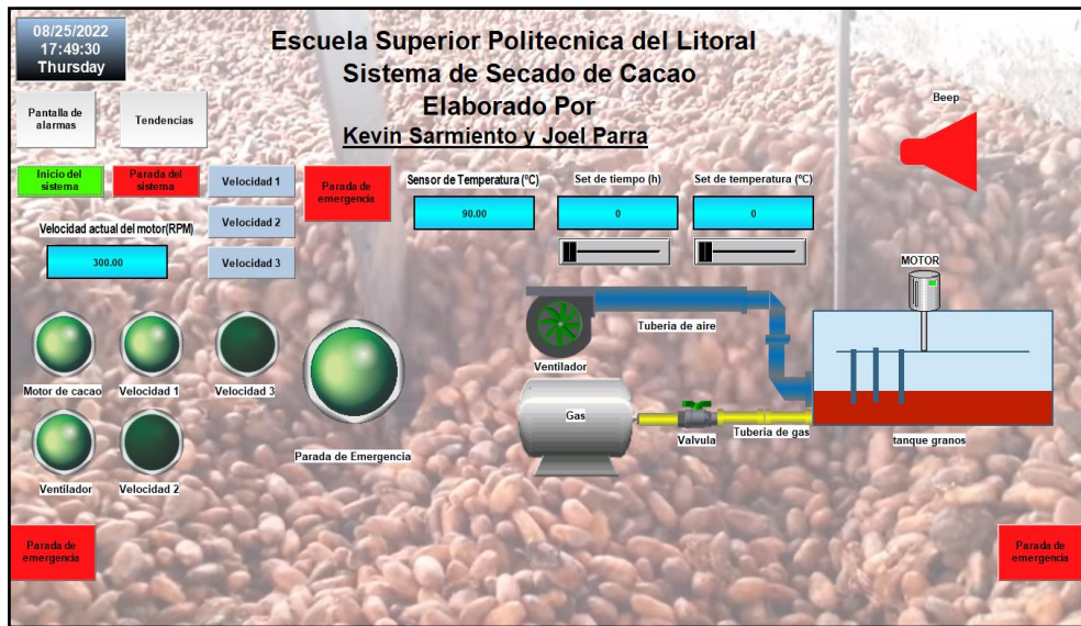
Figura 3-17 Sistema SCADA al iniciar
