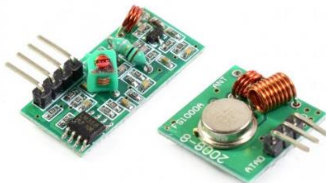
Figura 2-10. Módulos RF: TX Y RX [30].
