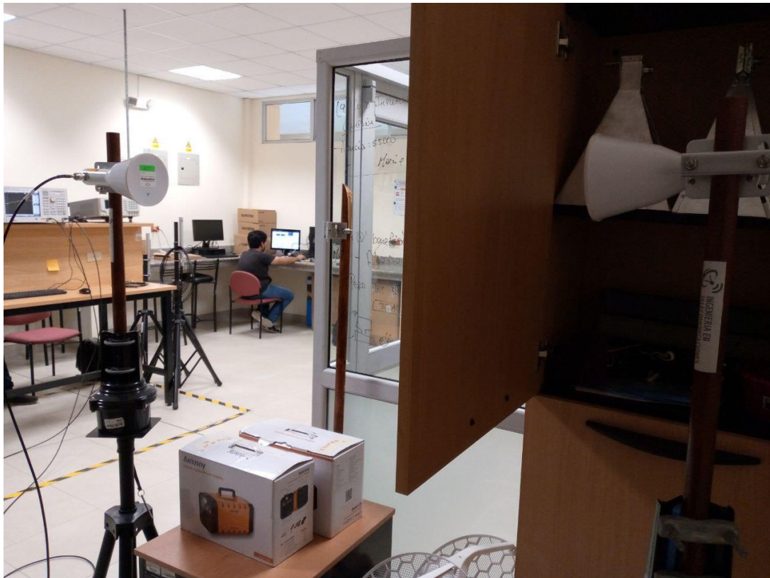
Figura 3.6. Medición de pérdidas de propagación en madera
