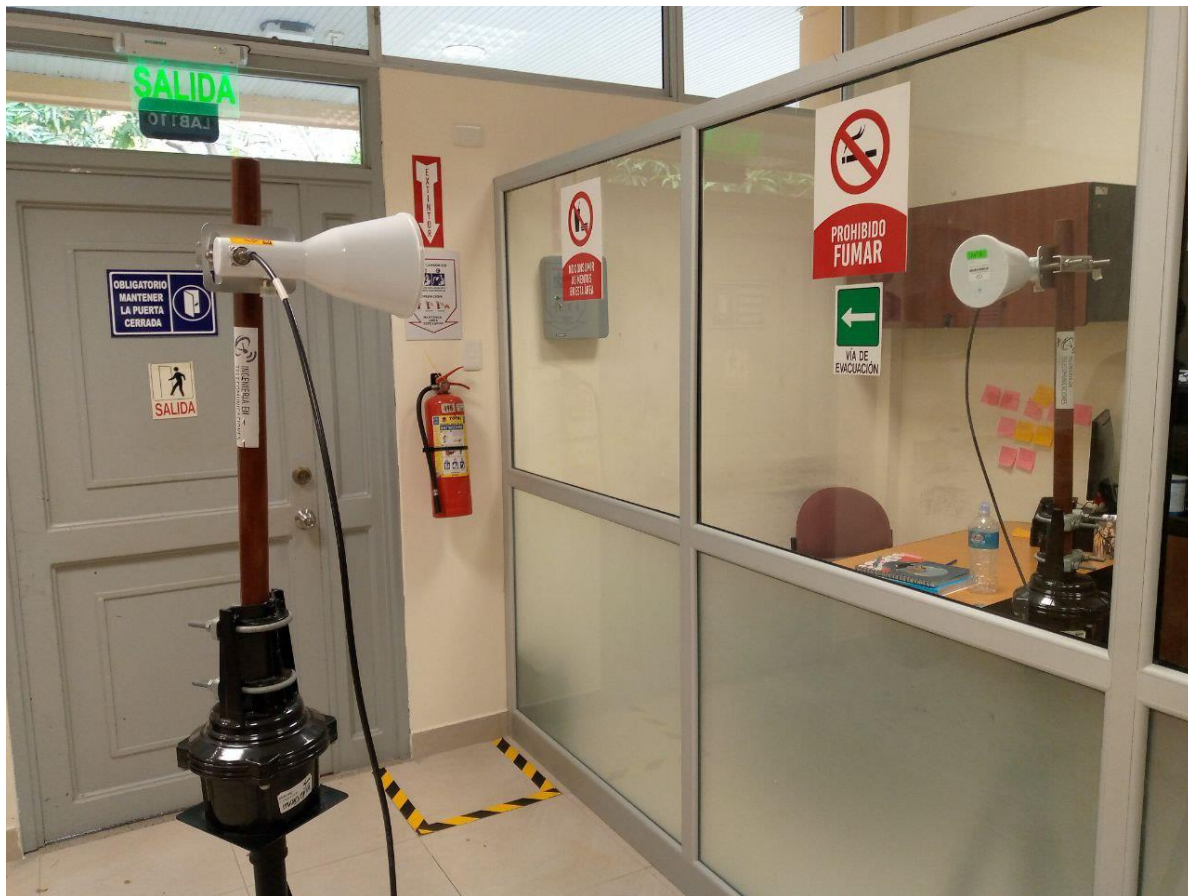
Figura 3.7. Medición de pérdidas de propagación en vidrio
