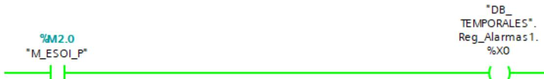
**Figura 3-9: Activación del bit del registro de alarmas**
