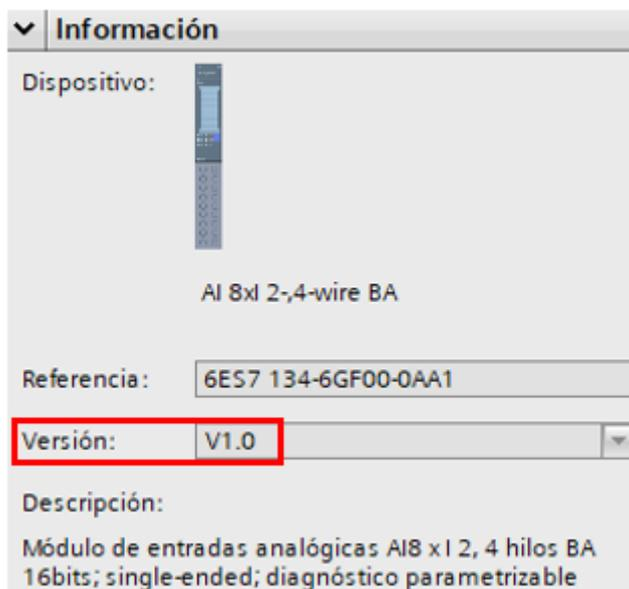
**Figura 2-28: Versión del firmware del módulo de entradas analógicas**
