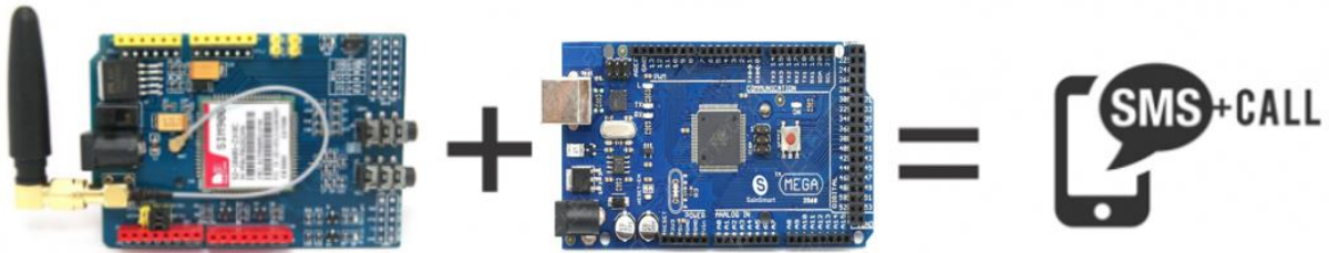
Figura 2.14 Diagrama de conexiones entre Arduino Mega y Módulo SIM900 [22].
