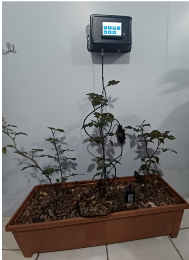
Imagen 3.4 Medición de los parámetros de agricultura de precisión con el equipo AgroScan
