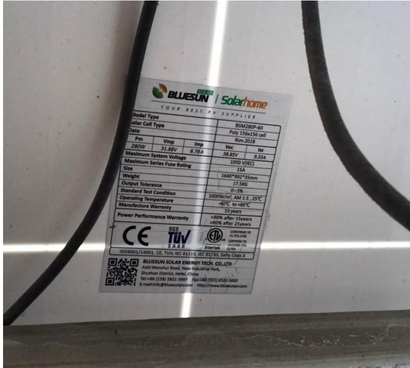
**Figura 2.12** Datos de los paneles BSM280P-60. Fuente: autores
