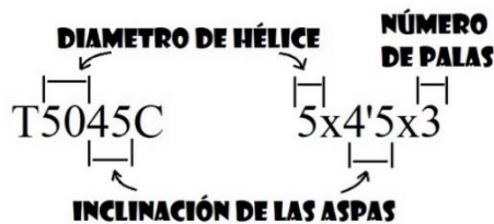
Ilustración 2.5 Nomenclatura y formato de hélices [15]
