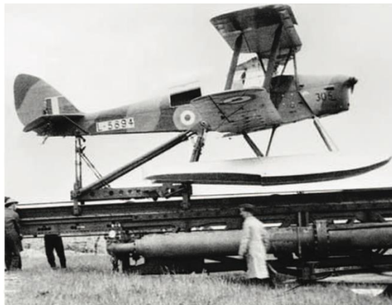
Ilustración 1.8 Lanzamiento de DH.82 Madre abeja (Madre de drones) “Target dron” [1].
