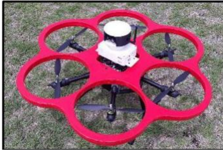
Figura 1.14 Hexacóptero para la inspección en redes de distribución [23]
