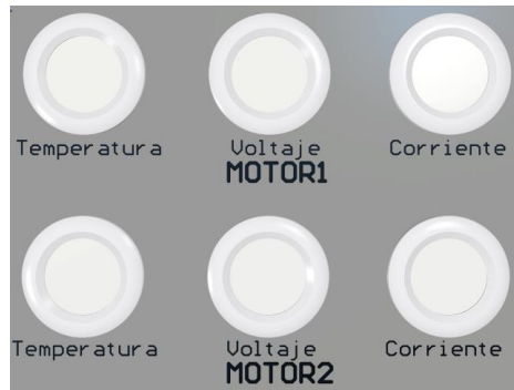
Figura 7: Bloque de indicación de alarmas del sistema.
