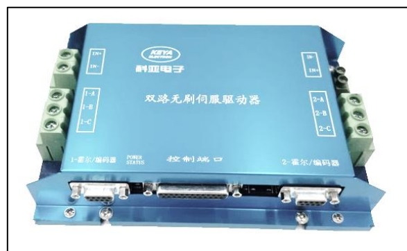
Figura 2.6 Controlador para motor DC, de dos canales.
