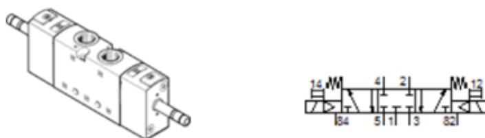
Figura 2.16 Electroválvula VUVS-L20-P53C-MD-G18-F7 con su esquema.
