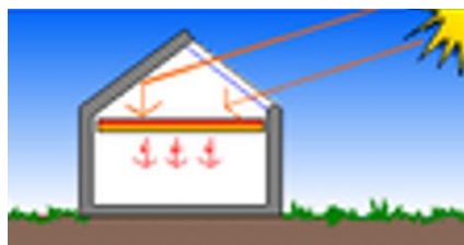
Figura 1.11 Funcionamiento del techo de acumulación de calor.
