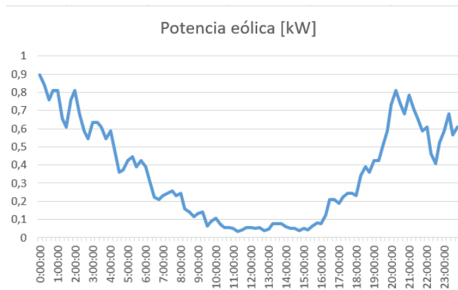
Ilustración 18: Generación promedio diaria del sistema eólico instalado por casa
