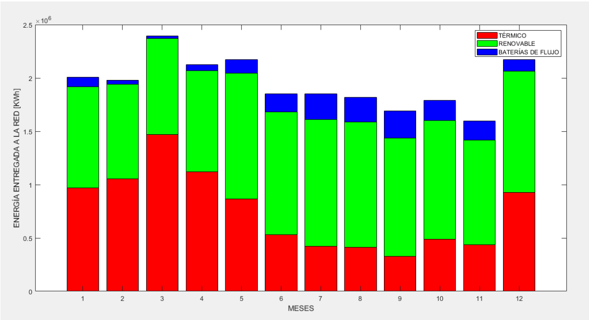
Imagen 3.10. Despacho de energía al implementar el sistema de almacenamiento en baterías de flujo.
