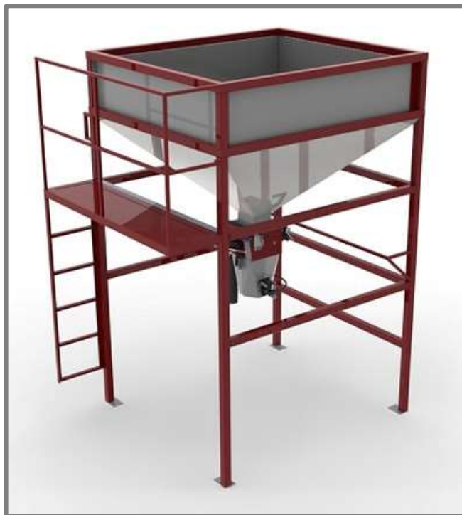
Figura 1.4 Bin de almacenamiento
