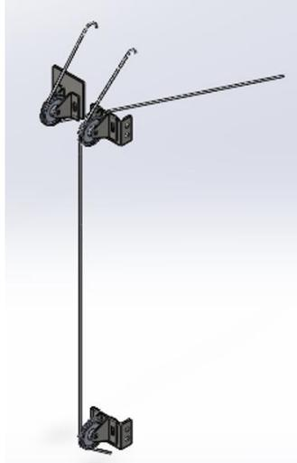
**Figura 2.8 Mecanismo de cables y poleas**
