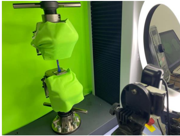
Figura 3.6 Configuración para ensayos de plásticos.
