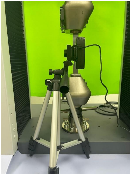
Figura 3.2 Colocación del sensor en la máquina de ensayos.
