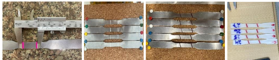
Figura 2.13 Ejemplos de marcadores en probetas metálicas (1 a 3) y plásticas (4).
