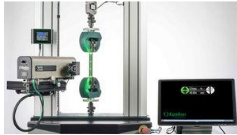
Figura 2.6 Funcionamiento de la Alternativa 2: Vídeo extensómetro.
