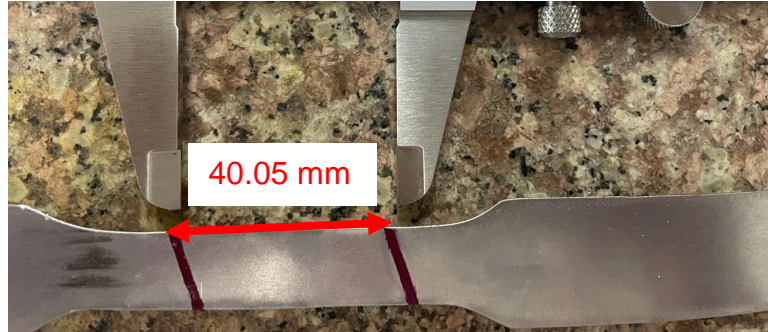
Figura 3.1 Toma de medida de referencia en probeta metálica.
