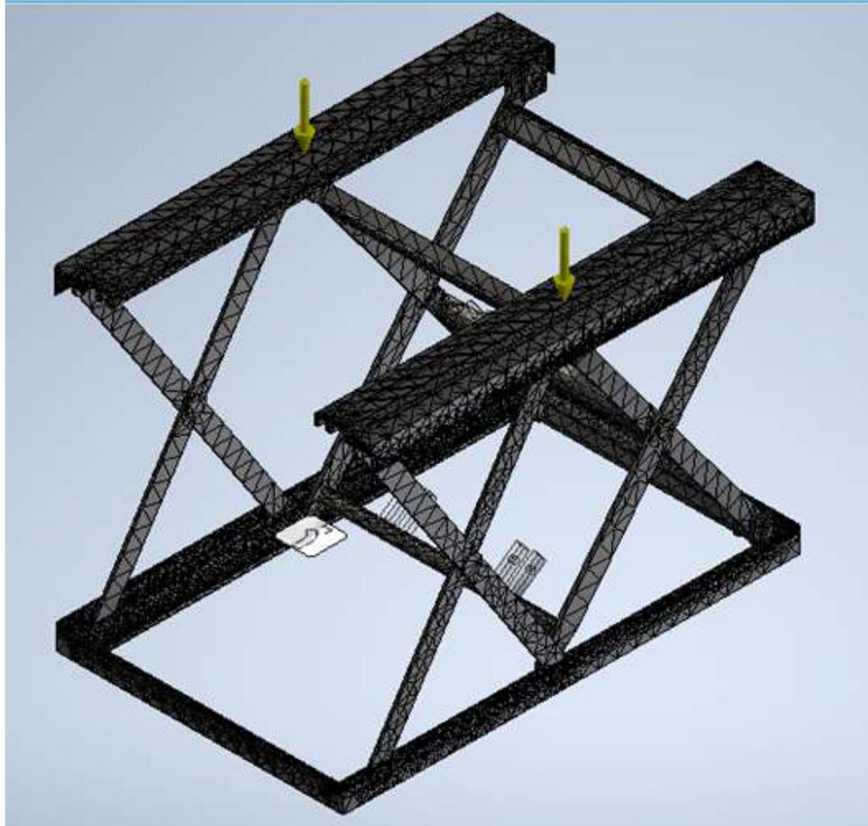
**Figura 3.13 Representación de mallado y carga sobre elevador de tijera**
