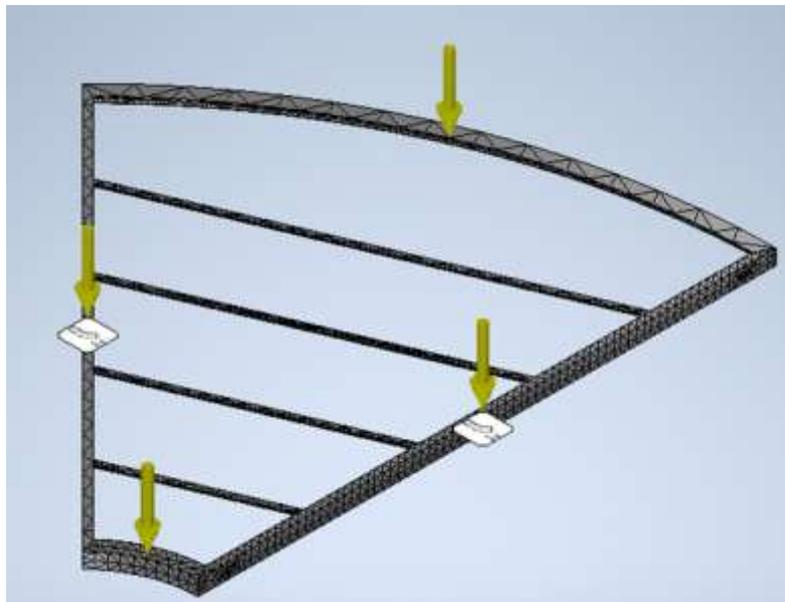
**Figura 3.15 Representacion de mallado y carga sobre 1 de los 8 elementos de la plataforma**
