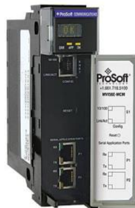
Figura 2.20. Módulo de comunicación Modbus MVI56E-MCM [20]
