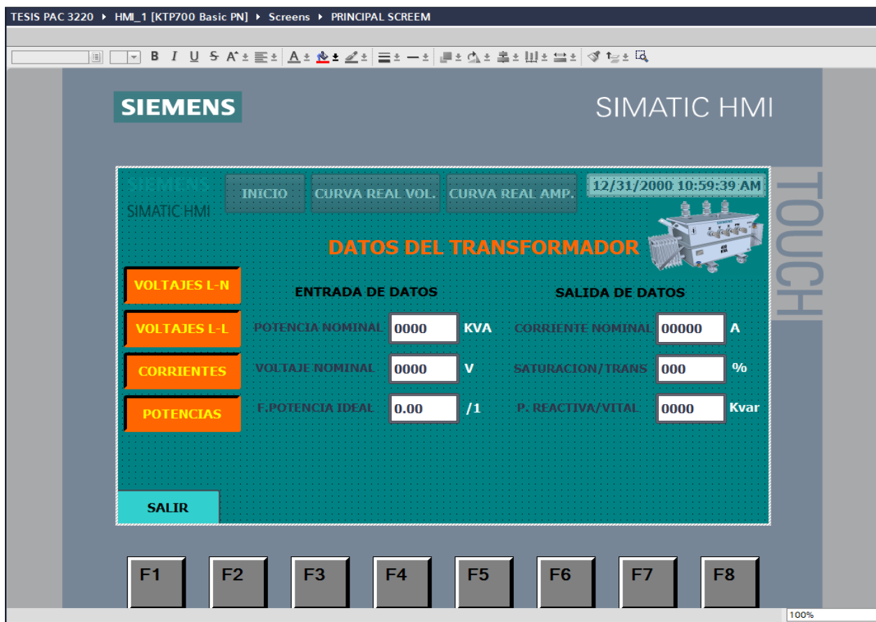
Figura 2-8 Diseño de la HMI datos del transformador
