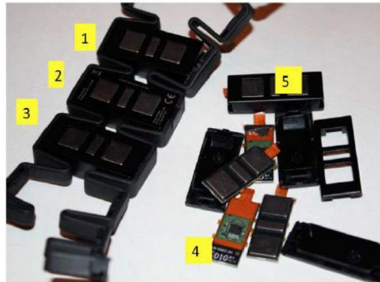
Figura 1.4: Composición interna de la MYO armband [22].
