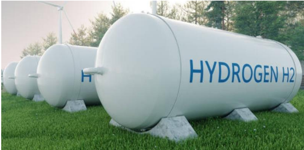
Ilustración 0.9. Tanques de almacenamiento de hidrógeno con capacidad de 3000 m 3 .
