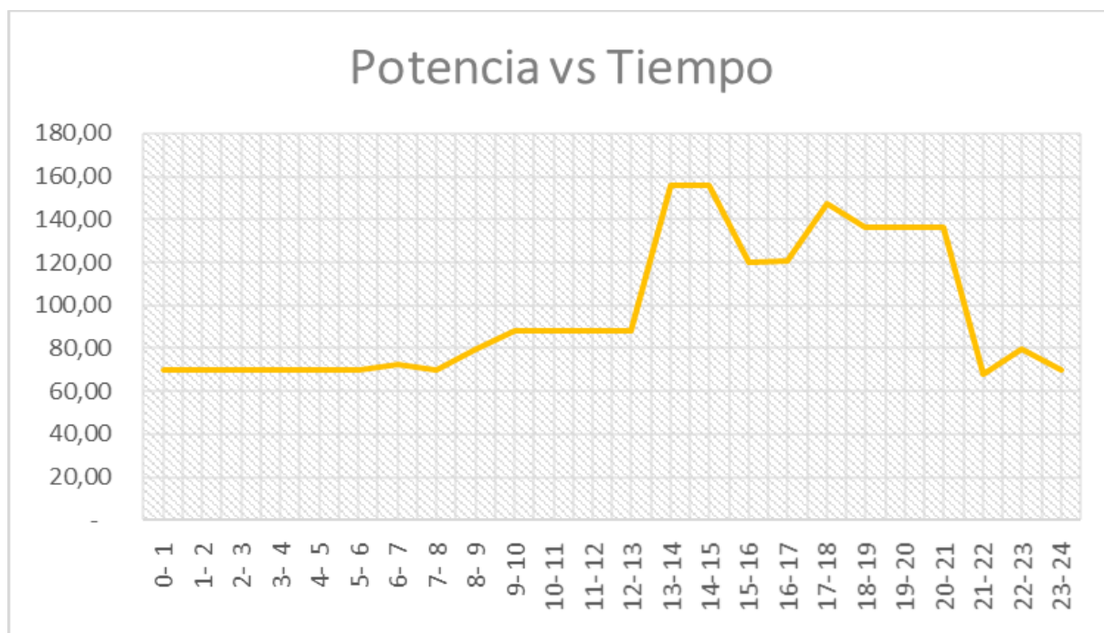
Ilustración 0.30. Curva de demanda diaria promedio incluyendo el escenario de operación de 20 horas diarias de la C. H. Daule-Peripa.
