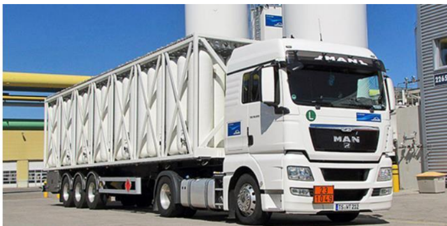
Ilustración 0.10. Camión cargado de Hidrógeno comprimido (Linde)
