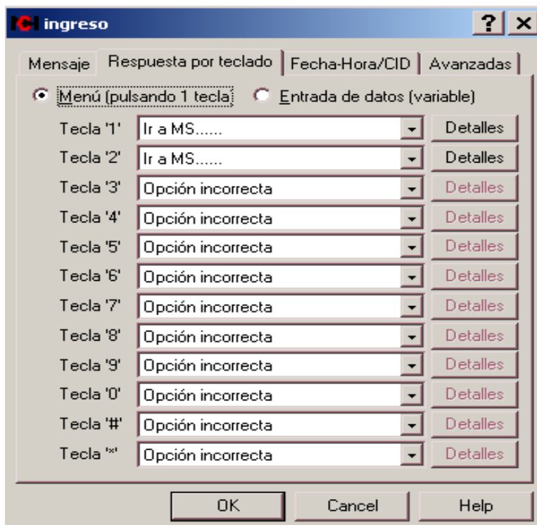
FIGURA 3.6 Configuración de todas las teclas posibles de un teléfono convencional.
