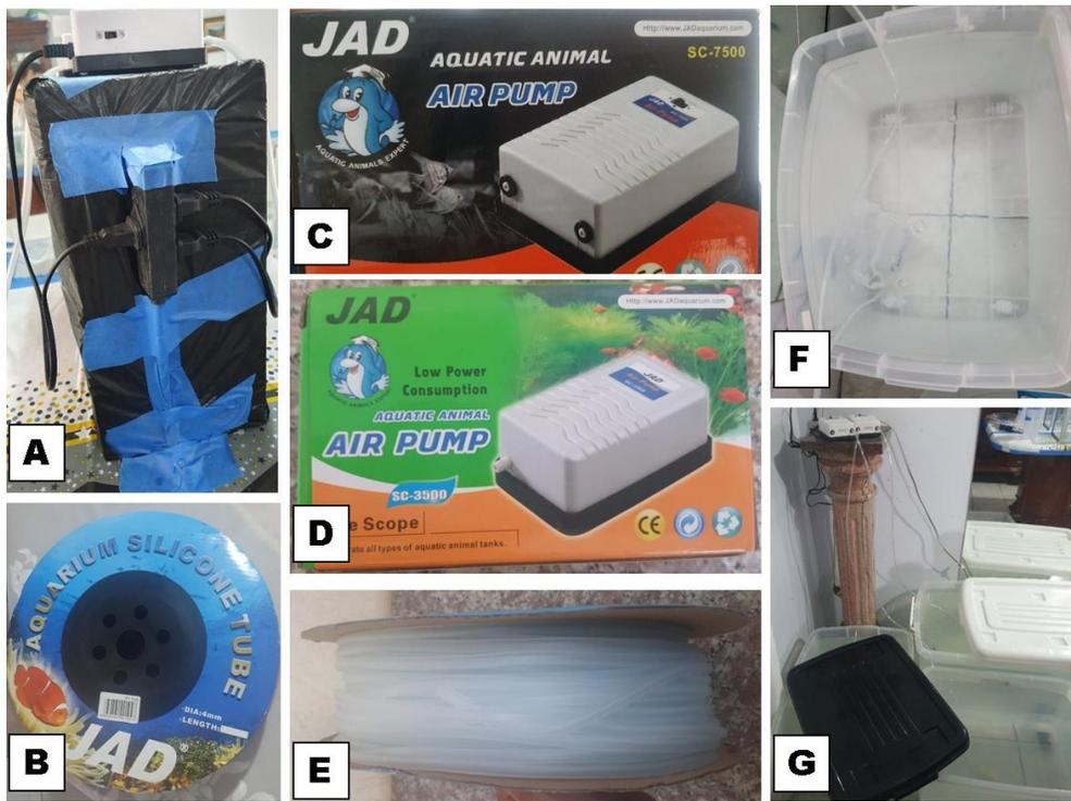
*Nota.* a) Regletas b) Manguera de silicona JAD, c) Aireador doble salida JAD, d) Aireador 1 salida JAD, e) Vista superior manguera silicona, f) Gaveta reservorio de 84 litros aproximadamente, g) Instalación de reservorio.
