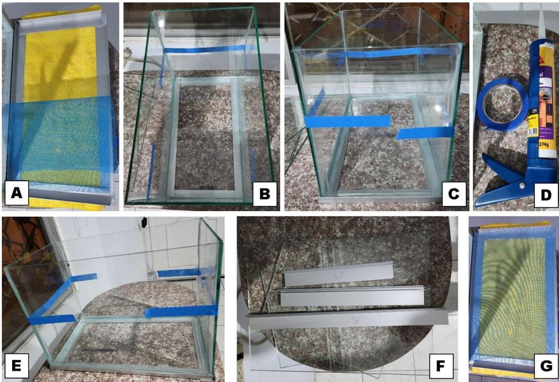
*Nota.* a) Malla de 1 mm y ángulos de aluminio para tapa, b) Vista superior acuarios reposición, c) Vista frontal acuarios reposición, d) Silicón para acuarios y masking tape, e) Vista lateral acuarios reposición, f) Vidrio de 3mm y ángulos, g) Tapa terminada acuarios reposición.
