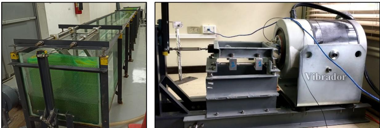
*Nota.* El generador de olas es de tipo pistón, el cual es accionado por el vibrador.
