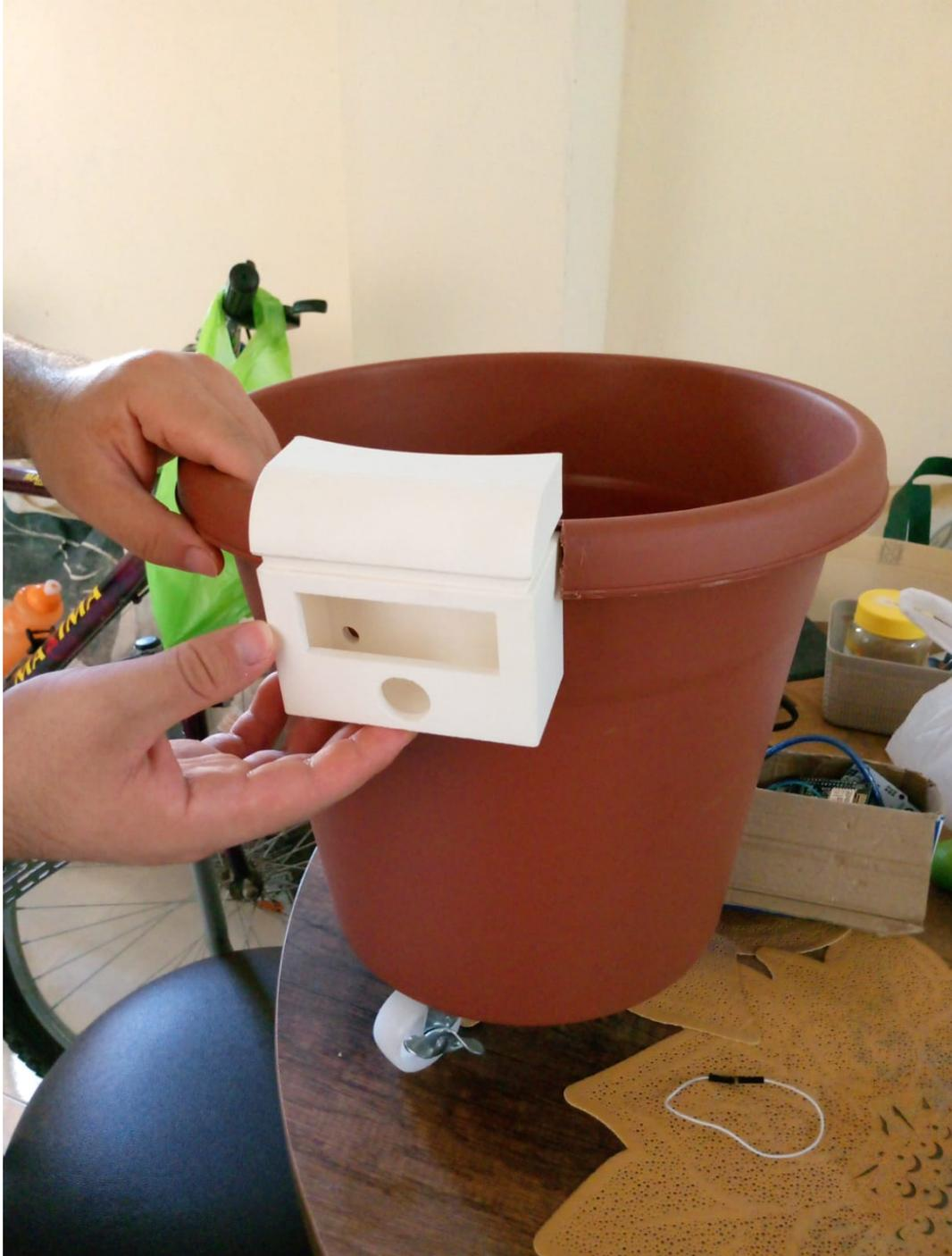
Figura C.7: Ubicando la caja de la pantalla y sensor de aire
