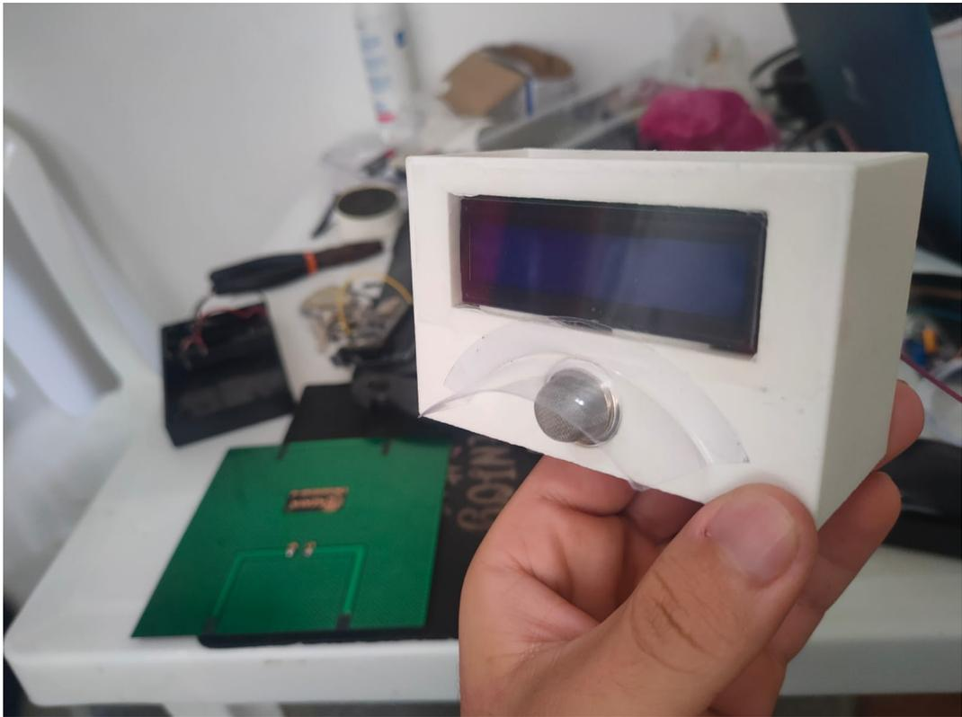
Figura C.8: Pantalla y sensor de calidad de aire agregados a la caja protectora
