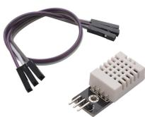
(a) Sensor de temperatura y humedad
