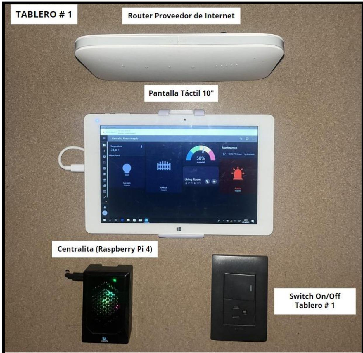
*Nota.* En la figura 3.2 se muestra el tablero # 1 detallando cada uno de sus componentes.
