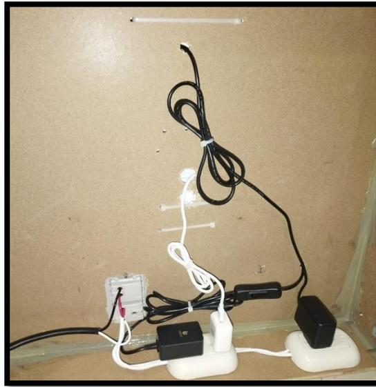
*Nota.* En las conexiones del tablero # 1 solo se emplean 3 cargadores que es para la Tablet, Router y Raspberry Pi 4
