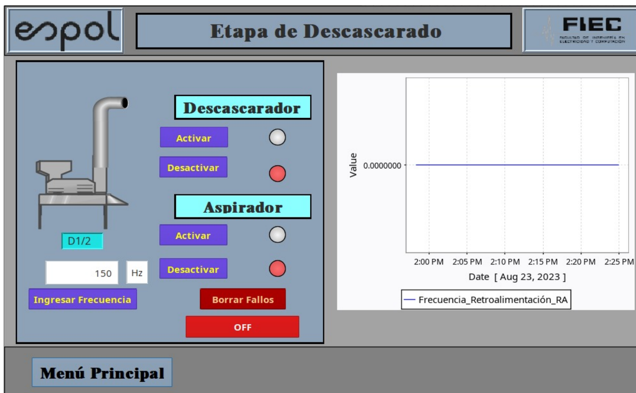
Ilustración 2. 59 SCADA – Pantalla Descascarado en Manual
