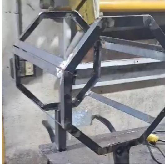
Continuando con la estructura, se construyó la base que soportaría todo el prototipo del fermentador y demás componentes que lo conforman, que incluye la base del motor y la superficie que recoge el mucilago; debido al considerable peso que debe soportar el armazón, fue fabricado con acero estructural ASTM A36. En la **figura 19** se presenta la estructura finalizada.
