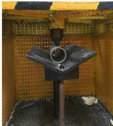
Figura 3.3. Ensayo de resistencia al impacto
