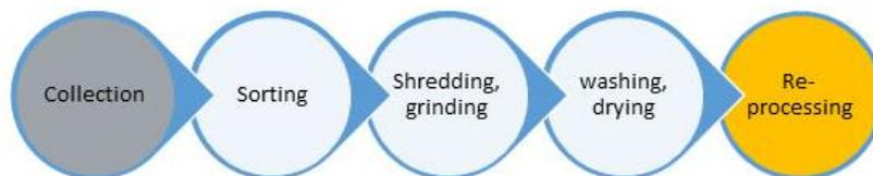
Figura 1.1. Procesos del reciclaje del PVC [6]
