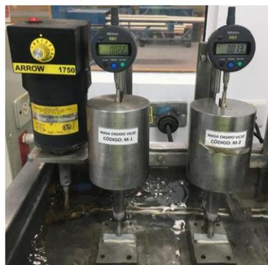
Figura 3.6. Probetas en evaluación usando equipo Vicat
