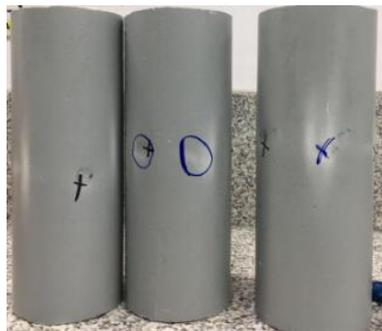
Figura 3.4. Probetas evaluadas mediante resistencia al impacto
