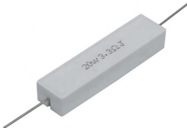
Como se puede observar en la Figura 16 las resistencias usadas fueron las de tipo tiza de cemento blanco. Estas resistencias tienen una potencia nominal de 5 W, 10 W y 20 W. Sus valores óhmicos son:
