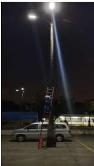
*Figura 2.5 Lectura de luminosidad a 4 metros sobre el nivel del suelo*
