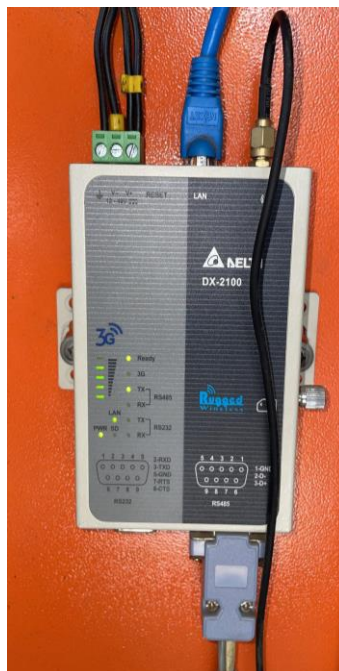
Figura 2.4 Conexión puerto RS-485 del router
