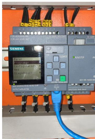
Figura 2.2 Descarga del programa en el controlador
