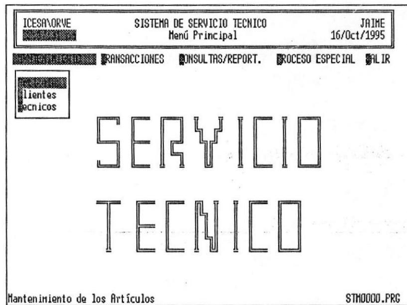
A continuación debe escogerse la opción a ejecutar mediante navegar a través del menú principal utilizando para esto las teclas de movimiento de cursor. La opción seleccionada se muestra en imagen reversa y se activa digitando la tecla [ENTER].
