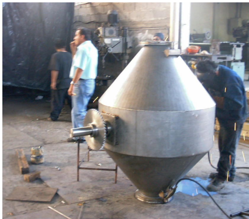
FIGURA 3.2. CONSTRUCCION DEL MEZCLADOR.
