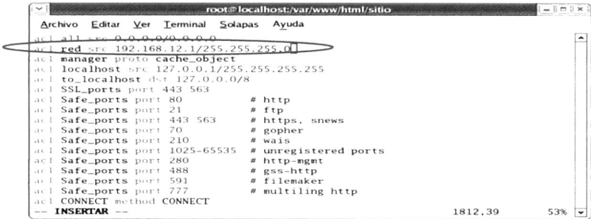
Figura 5-90 Se edita la siguiente línea en la sección de las ACL
