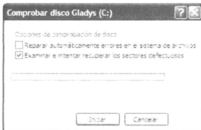
Figura 2.22. Examinar e Recuperar sectores Defectuosos.
