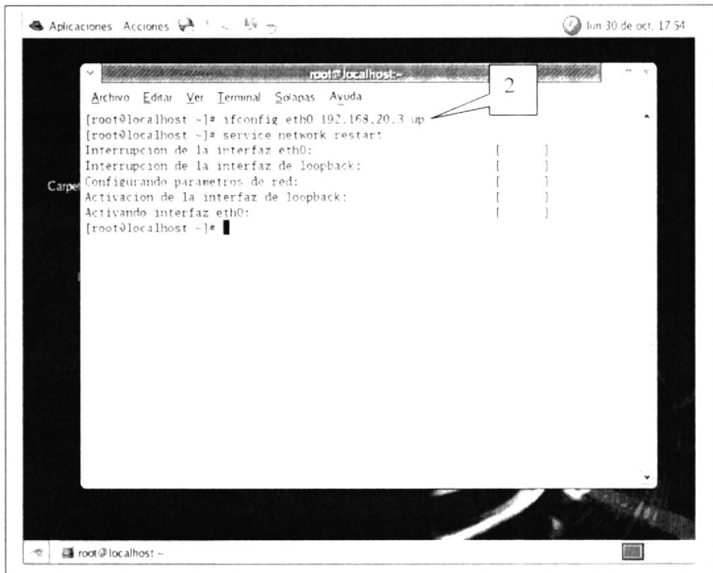
Figura 6-50: levantamiento de la tarjeta de red
