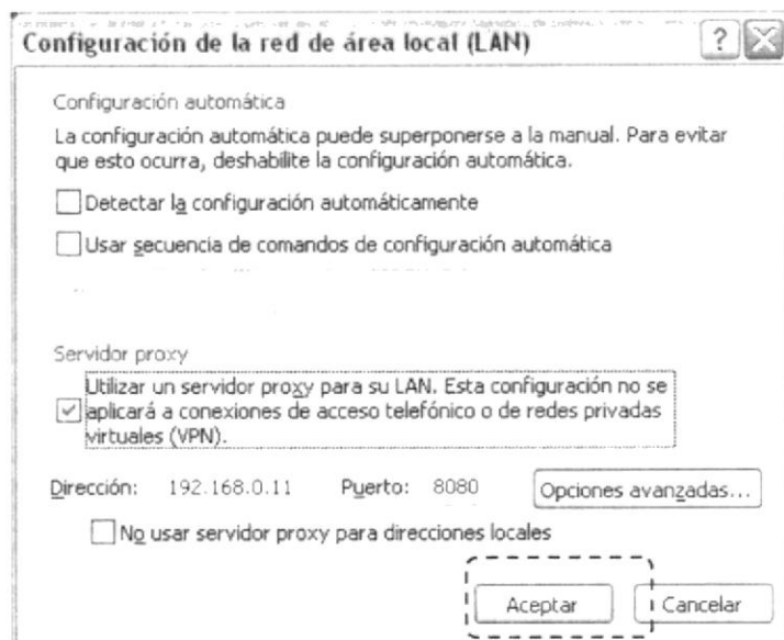
Figura 6-122: Configuración de conexión a través de Proxy en Internet Explorer
