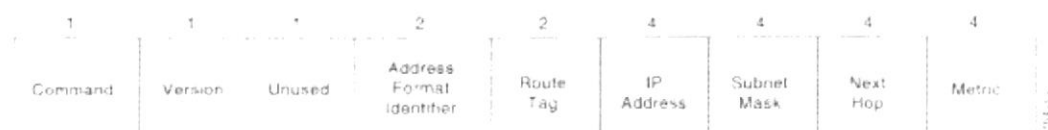
Figura 7-14: Campos de un paquete RIPv2
