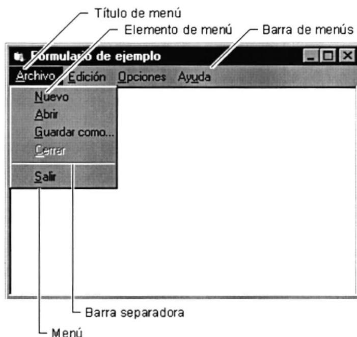
Figura 2.8 Elementos de un menú bajo ambiente Windows
