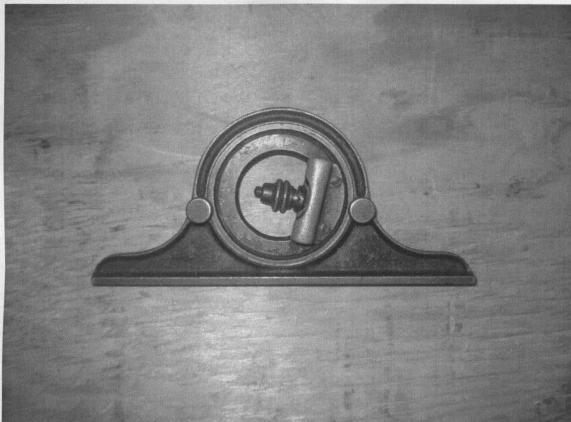
Fig. 33. Medidor de ángulo o Goniómetro usado para calibrar las cuchillas de tierra.
