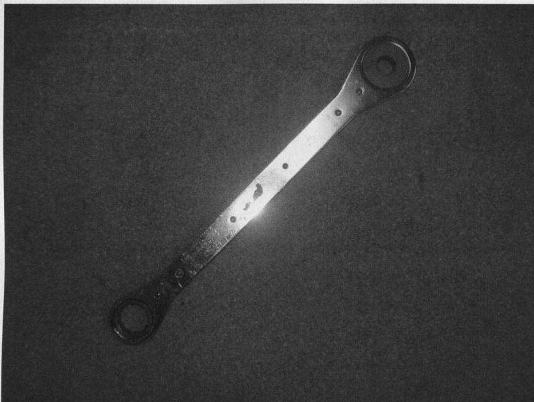
Fig. 29. Llave de tuercas tipo rachee, usada para apretar pernos en las alturas.
