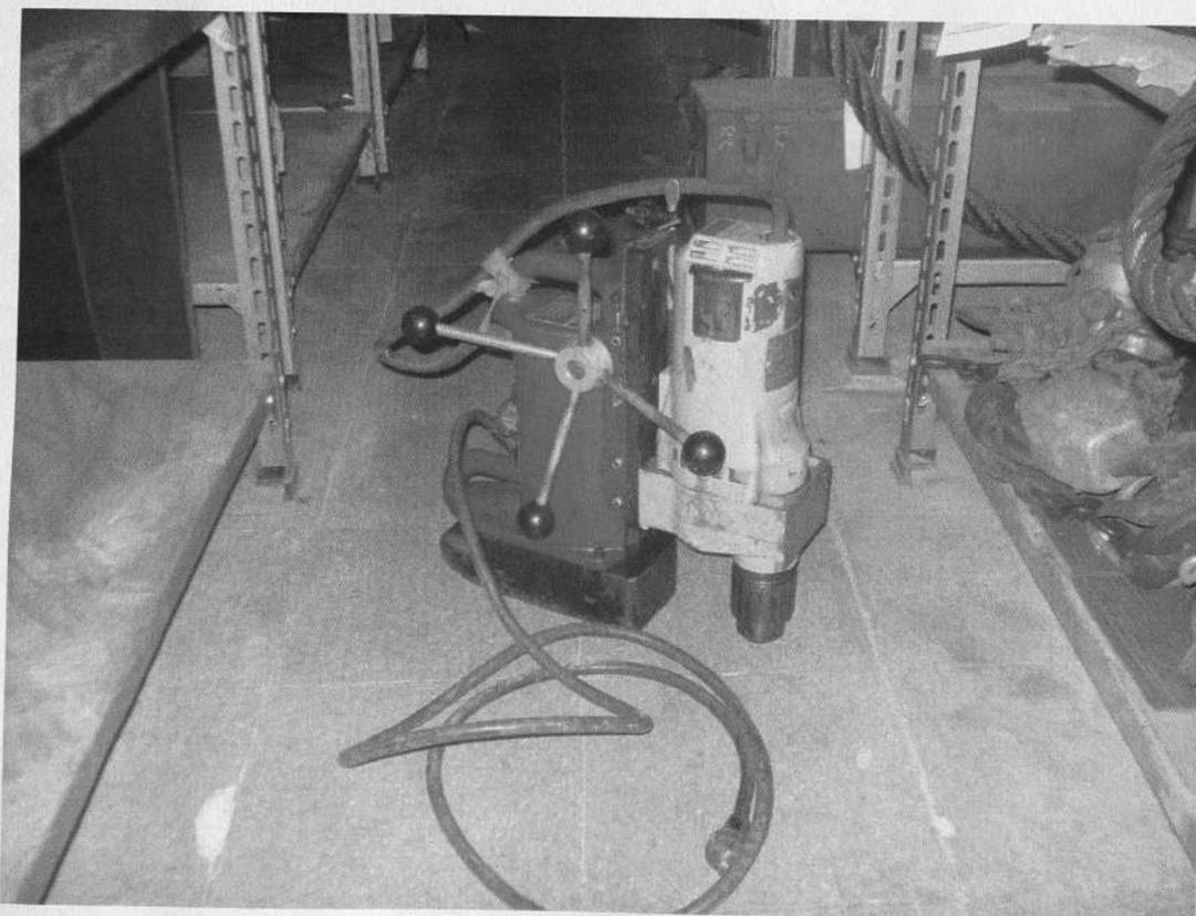
Fig. 32. Taladro Magnético usado para hacer orificios que necesitaban la mayor precisión posible.
