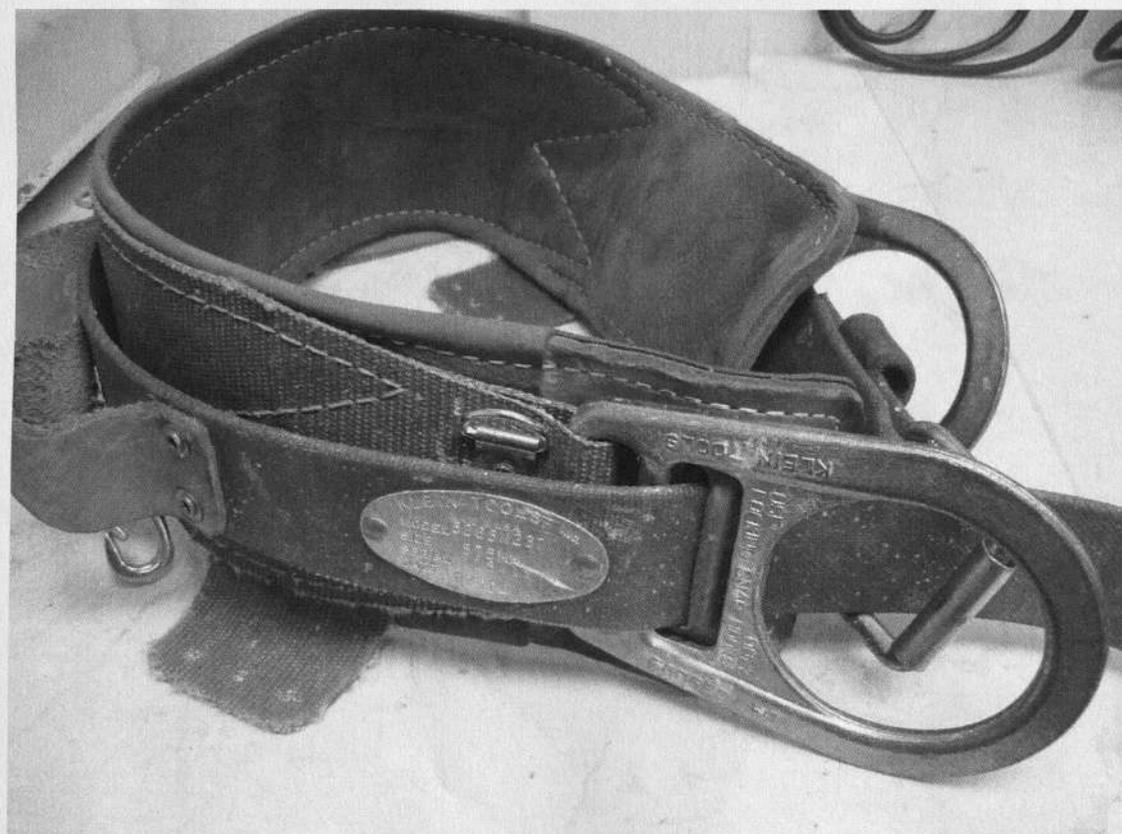
Fig. 34. Cinturón de Seguridad utilizado para trabajar en alturas.
