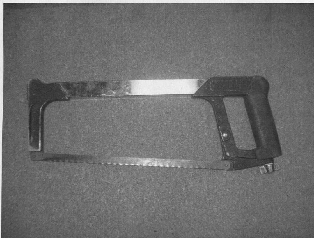
Fig. 22. La sierra, que fue usada para cortar cables de cobre y aluminio de 1.000 y 1.500 MCM.
