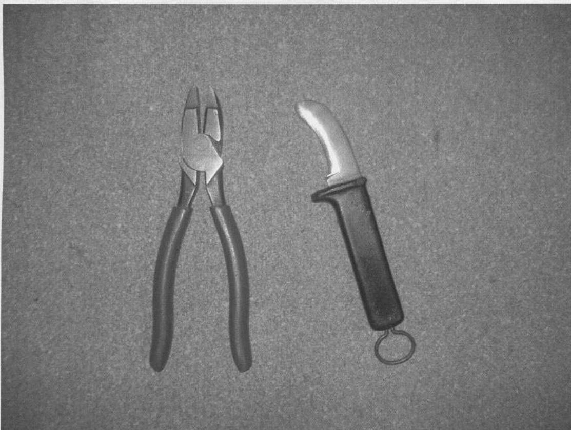
Fig.20. Playo y cuchillo curvo usados para cortar y pelar cables que fueron usados en el proyecto, capacidad de aislamiento 1.000 V.
