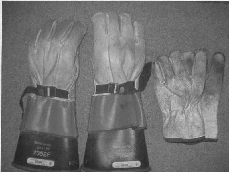
Fig. 28. Guantes de alta tensión con capacidad de aislamiento de 13.600 V, usados para abrir cuchillas con pertiga, y guantes para trabajos forzados que también poseen una capacidad de aislamiento de 600V.
