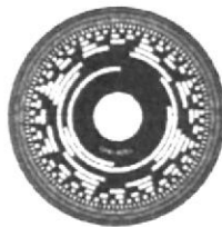
Figura 1-45: Disco con ranuras y huecos transparentes para encoder absoluto
