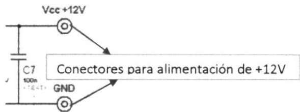
Figura 3-48. Conectores bananas agregados al C4 para la alimentación de +12V
