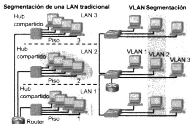
Figura 5.67 Comparación de una LAN tradicional y una VLAN
