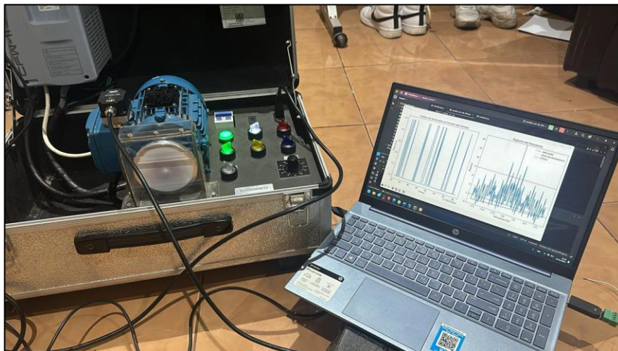
Figura 89. Pruebas de vibración con una maleta de pruebas con motor de 0.5 HP y un variador de frecuencia
