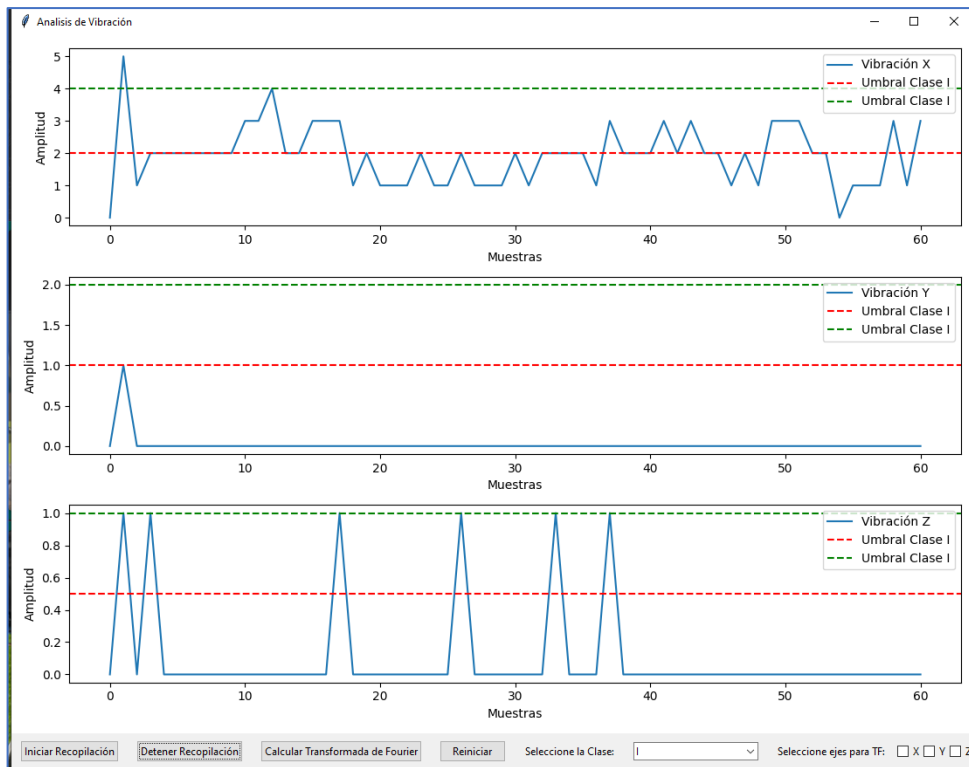
Figura 5. Interfaz del programa realizado en Python para el análisis de vibraciones.
