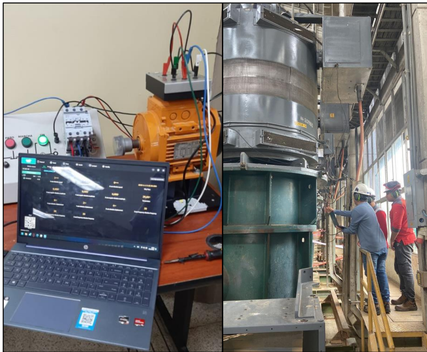
Figura 84. Pruebas realizadas con el sensor en una máquina de clase I y clase III según la norma ISO 2372
