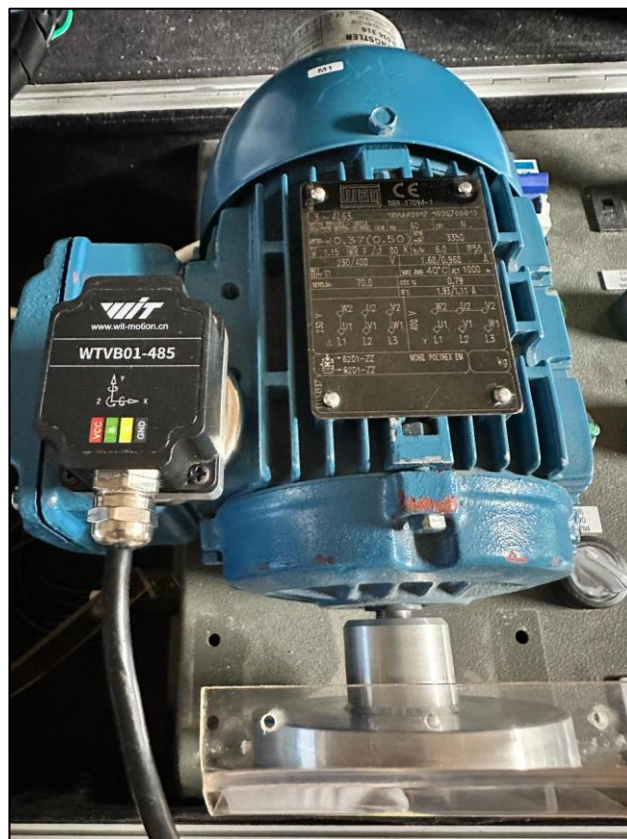
Figura 69. Ubicación del sensor de vibración en el motor para las pruebas de funcionamiento.
