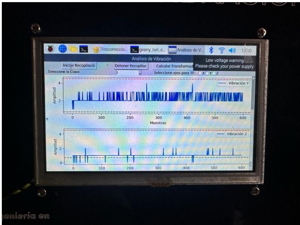
Figura 79. Estado vibracional en el dominio del tiempo del eje Y y Z cuando se altera la estructura del motor
