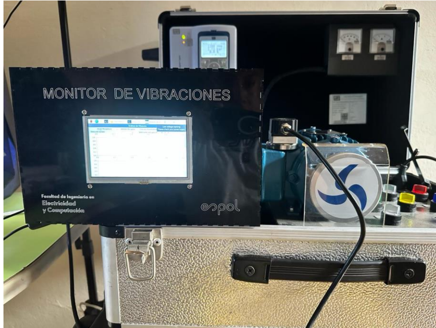
Figura 100. Tablero monitor de vibraciones con sistema operativo Raspbian en un Raspberry Pi 3 en pruebas de funcionamiento con maleta de pruebas
