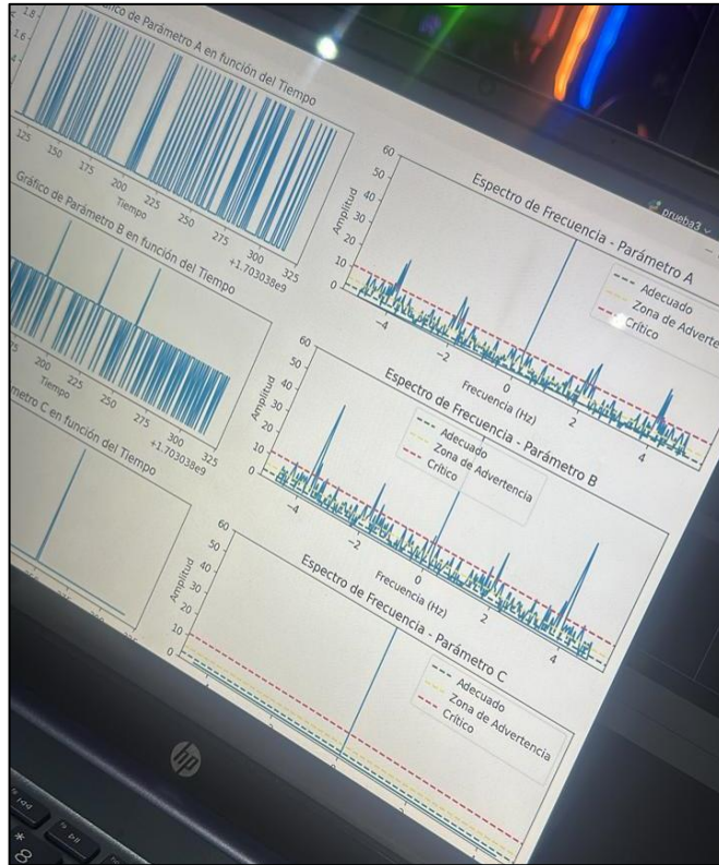
Figura 92. Resultados obtenidos con la actualización de la interfaz del programa con sistema de monitoreo y espectro vibracional en tiempo real
