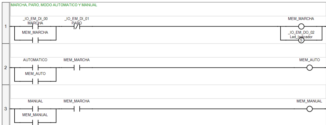
Figura 3.1 Marcha, Paro y Modos de Funcionamiento
