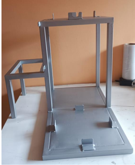
Figura. 3.5 Aplicación de capa de pintura a la estructura metálica
