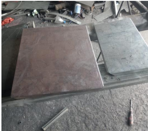
Figura. 3.1 Planchas de acero galvanizado para el prototipo base.
