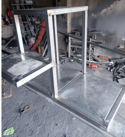
Figura. 3.3 Estructura metálica finalizada
