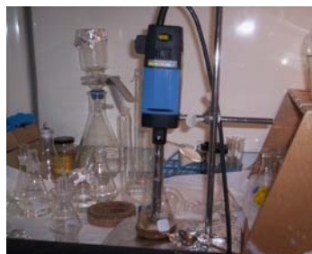
FIGURA 2.17 ADICIÓN DE DICLOROMETANO:HEXANO(1:1) A LA MUESTRA
