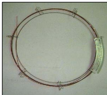
FIGURA 1.12 COLUMNA CAPILAR PARA CROMATÓGRAFO DE GASES
