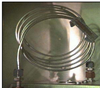
FIGURA 1.11 COLUMNA EMPACADA PARA CROMATÓGRAFO DE GASES
