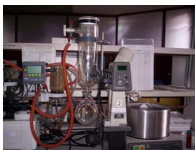
FIGURA 2.20 CONCENTRACIÓN DE LA MUESTRA BANANO CON ROTAEVAPORADOR
