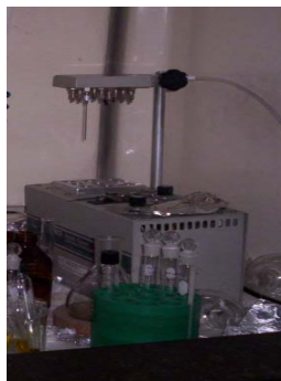
FIGURA 2.21 CONCENTRACIÓN DE LA MUESTRA CON NITRÓGENO
