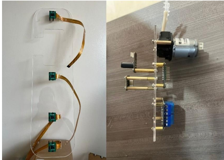
Ilustración 2.21 Soporte de acrílico para conjunto de cámaras y sensores
