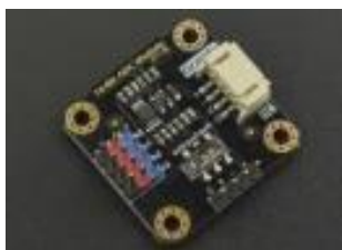
Ilustración 2.12 Módulo I2C ADS1115 (DFRobot, s.f.)
