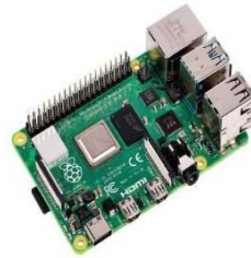
Ilustración 2.6 Raspberry Pi 4 Modelo B (Rus, 2019)
