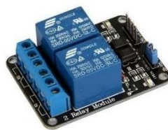
Ilustración 2.11 Módulo Relé de 2 canales (AVElectronics, s.f.)
