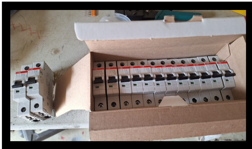
Figura 6.3. Breakers de protección de los equipos
