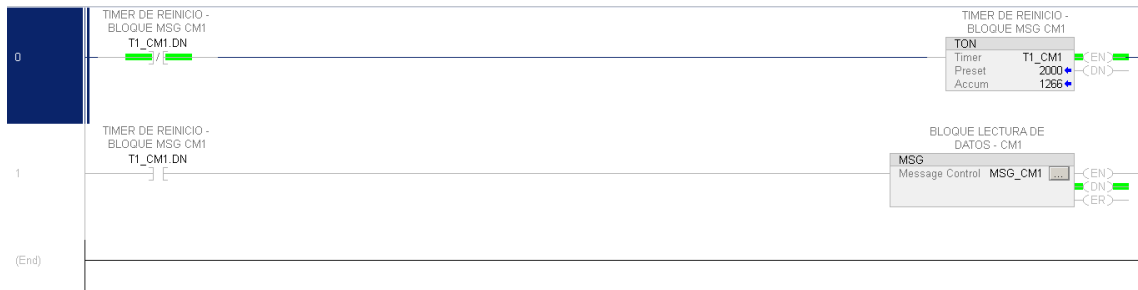
Figura 2.29. Programación de reinicio de bloque MSG para actualización de datos CM1
