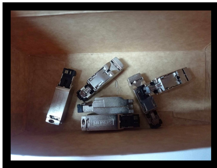
Figura 6.6. Conectores RJ45 de los cables EtherNet
