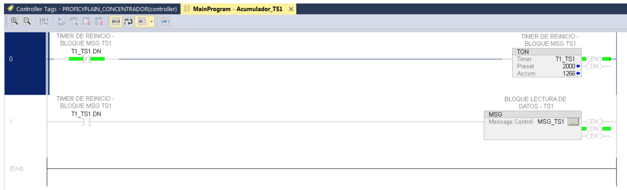
Figura 2.17. Programación de reinicio de bloque MSG para la recepción de los datos TS1
